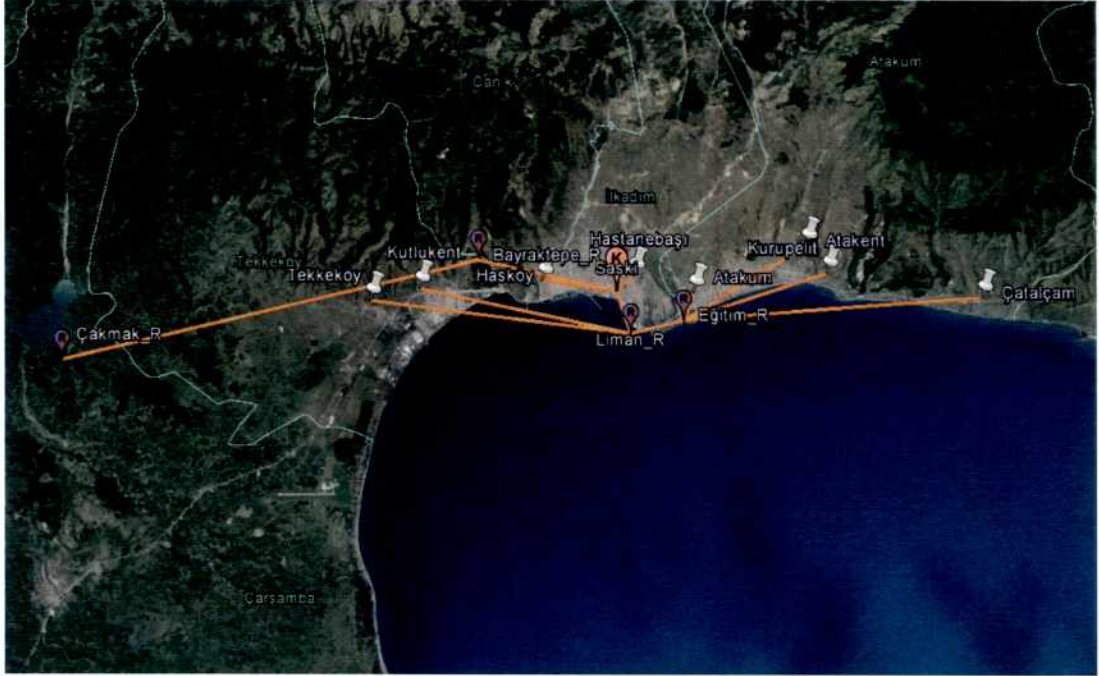
Şekil 6.13. SASKİ SCADA Sistemi Haberleşme Ağı
